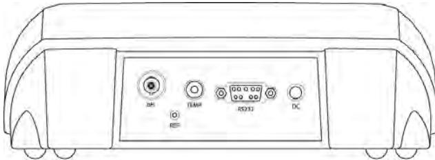
Para o eletrodo ST310, deve-se conectar o soquete BNC e Cinch. Para eletrodo pH 2 em 1 (ST210), só é necessário conectar o BNC.
