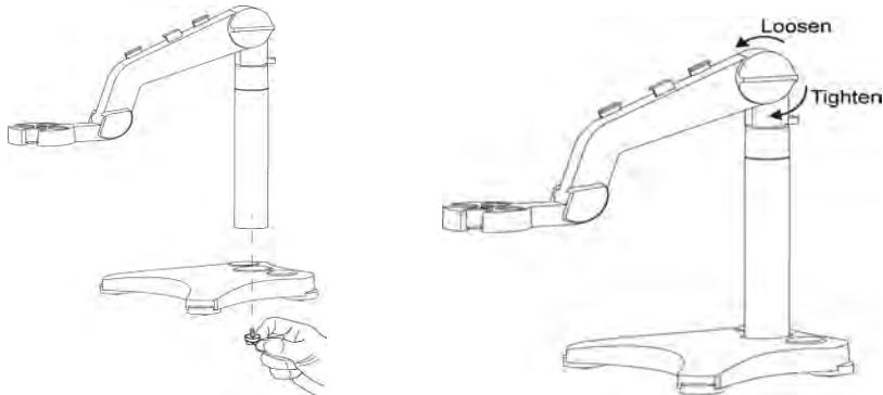
Después de ajustar hasta cierto punto el mando de tensión, puede mover hacia arriba y hacia abajo la parte superior del brazo directamente. Al colocar el electrodo del pH en el brazo y realizar la calibración o medición, se puede colocar el frasco de almacenamiento del electrodo de pH en el hueco de la base.
