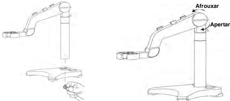
Após a ajustar o botão de tensão em certa medida, você poderá levantar e abaixar diretamente o braço. Quando colocamos um eletrodo de pH no braço e executarmos calibração ou medição, podemos colocar o frasco de armazenamento do eletrodo de pH no orifício da base.
