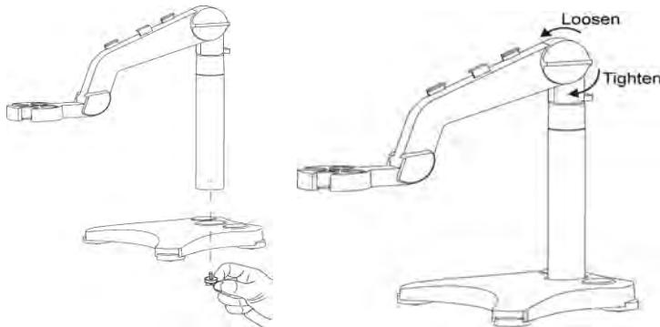
Après avoir réglé le bouton de tension jusqu'à un certain niveau, il est possible de déplacer directement le bras supérieur vers le haut et vers le bas. En plaçant l'électrode de pH sur le bras et en réalisant un étalonnage ou une mesure, il est possible de ranger la bouteille de stockage de l'électrode de pH dans l'orifice de la base.
